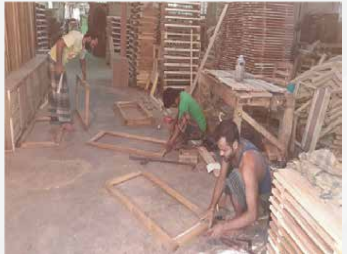
চিত্র ৫.৪: বশিউক, ফিডকো ফার্গিচার কমপেক্স, কালুরঘাট, চট্টগ্রামে সিজনিং ও ট্রিটমেন্টকৃত উন্নতমানের রাবার কাঠ দ্বারা ফার্গিচার তৈরী করা হচ্ছে।
