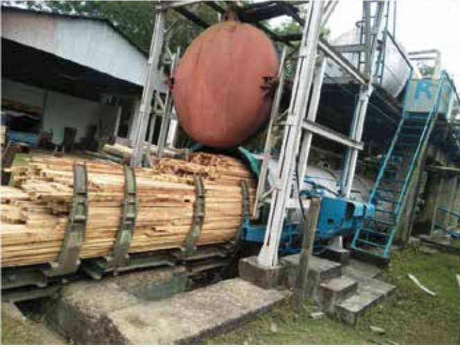
চিত্র ৫.১: বশিউক, লাম্বার প্রসেসিং ইউনিট, কাগুই, রাঙ্গামাটিতে রাবার বাগান হতে আহরণকৃত জীবনচক্র হারানো রাবার গাছ হতে প্রাপ্ত সাইজ কাঠ ট্রিটমেন্ট করা হচ্ছে।
