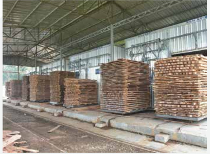
চিত্র ৫.২: বশিউক, রাবার কাঠ প্রেসার ট্রিটমেন্ট পান্ট, শ্রীমঙ্গল, মৌলভীবাজারে ট্রিটমেন্টকৃত রাবার সাইজ কাঠ সিজনিং এর জন্য সিজনিং চেম্বারে প্রবেশ করানো হচ্ছে। যা হতে উন্নতমানের সিজন্ড ও ট্রিটেড রাবার কাঠ পাওয়া যাচ্ছে।
